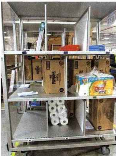
Un système de rebin, passant du batch de picking à une armoire à casiers conçue sur mesure, pour des commandes multiples. Le logiciel d'Amazon permet de regrouper les commandes identiques.
