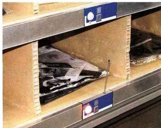
●●●●● Une antenne permet de vérifier que l'article a bien été déposé dans le bon casier.
